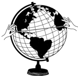
Рис. 3. Простой способ отыскания действительно кратчайшего пути между двумя пунктами: надо на глобусе натянуть нитку между этими пунктами
