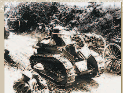
Танки «Renault» FT-17 на марше. Британские пехотинцы почтительно расступились, чтобы дать дорогу технике поддержки. На фото — пулеметный танк, вооруженный 8-мм пулеметом «Hotchkiss».
