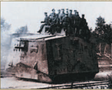
Немецкий танк А7V на марше. При выборе пушечного вооружения этой машины было решено по примеру англичан ограничиться 57-мм орудием.
