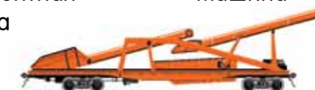
Очистной модуль щебнеочистительной машины
