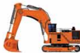
Гидравлический карьерный экскаватор
