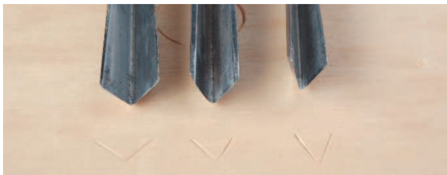
Стамески-уголки (разделительные стамески) бывают с тремя углами. Справа налево на фото: 45°, 60° и 90°.
