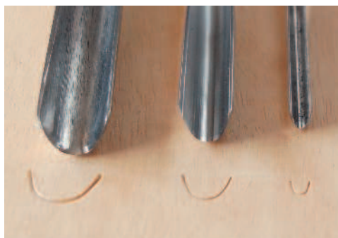
Церазики: стенки лезвий могут быть параллельными или слегка расходиться в стороны.
