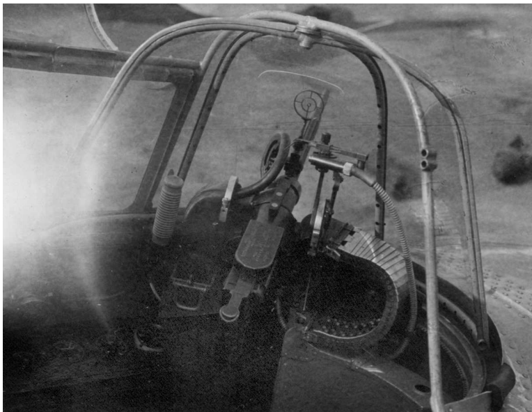
Стрелковая оборонительная установка штурмана-стрелка на БШ-2
