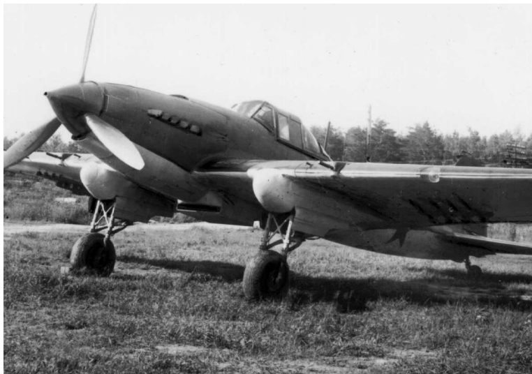
Серийный Ил-2 АМ-38 с пушками ВЯ-23 производства завода №18. Весна 1942 г.
