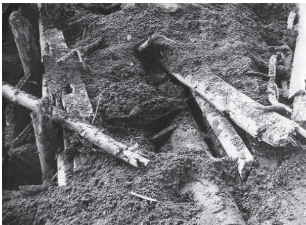
Фугасное и осколочное действие 120-мм снарядов с готовыми нарезками на пояске произвело сильное впечатление на потенциального заказчика
