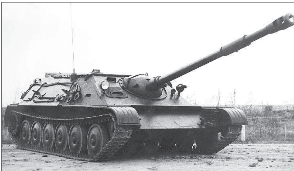
Самоходная артиллерийская установка СУ-85 придала воздушному десанту дополнительную огневую мощь и маневренность, но оставалась прежде всего противотанковым средством. СУ-85 была разработана под руководством Н.А. Астрова на Мытищинском машиностроительном заводе. 85-мм пушка Д-70 — под руководством Ф.Ф. Петрова в ОКБ завода №9
