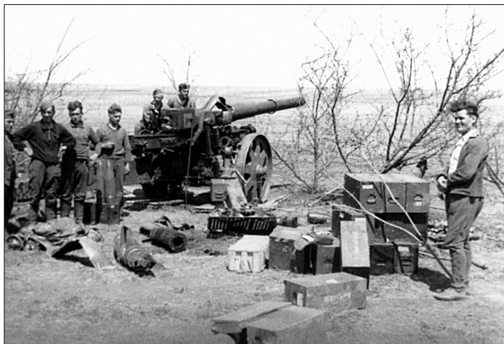
Фрагменты, собранные после разрыва ствола. Расчет еще потрясен близостью смерти. Вюстер рисковал, снимая это: фотографировать разрыв ствола было запрещено
