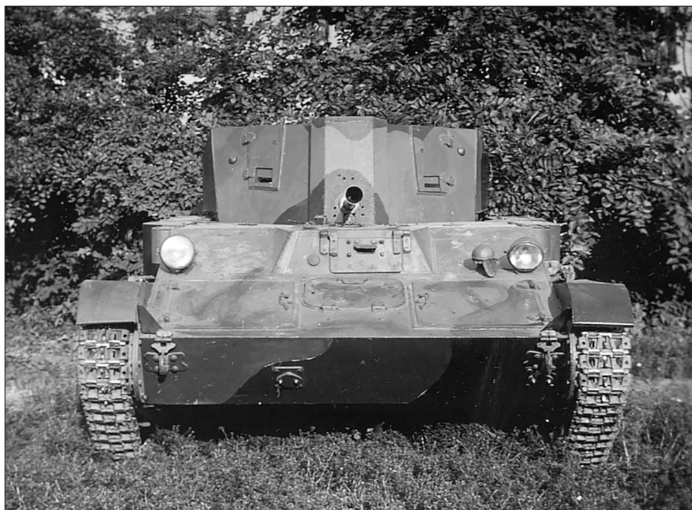
В конструкции СУ-31 хорошо видны узлы и детали, заимствованные у Т-60
