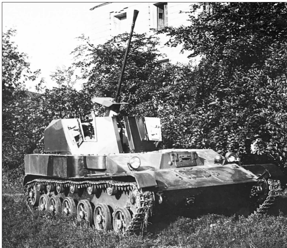
Опытный образец САУ СУ-31, вооруженный 37-мм автоматической пушкой 61К. Август 1942 года
