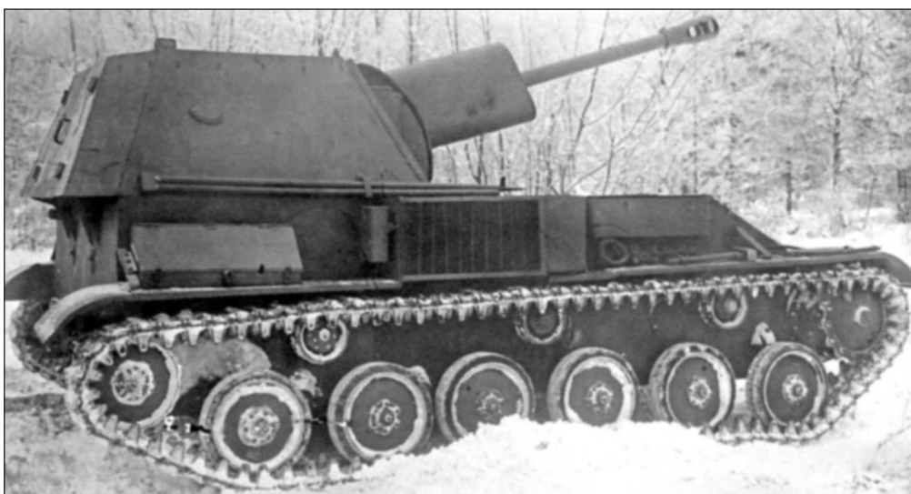
Опытный образец САУ СУ-12. Орудие на максимальном угле возвышения
