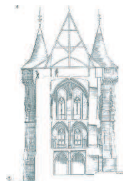
Рис. 6. Донжон в Пуатье в разрезе
