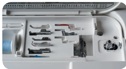
В швейных машинах предусмотрены специальные места для удобного хранения аксессуаров: отделение со стороны «свободного рукава» или, как здесь, отделение в верхней части машины
