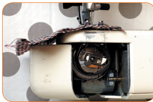
Вертикальный челнок механической машины с установленной шпулькой
