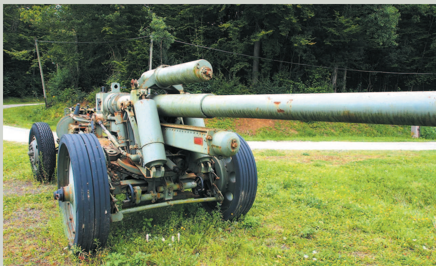
Немецкая тяжелая 105-мм пушка в походном положении.
