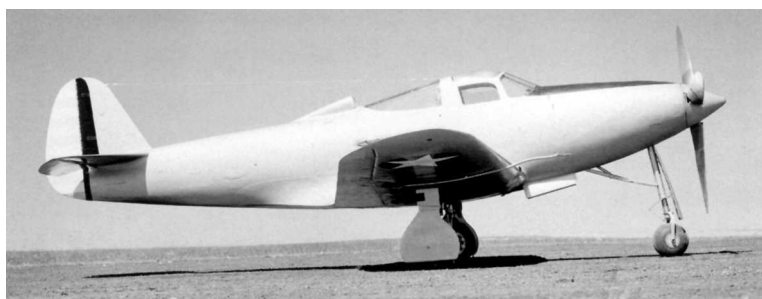
XP-39В весной 1940 г. Размеры всасывающего патрубка двигателя увеличены, изменены щитки носовой стойки шасси
