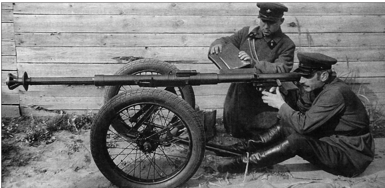
Одно из разрабатывавшихся перед войной опытных ПТР — 20-мм ротное противотанковое ружье Блюма—Владимирова. Фото из книги «Энциклопедия ковровского оружия» (1918–1966 гг.). По материалам архива КБ «Арматура» — М. : Худож. Лит., 2012
