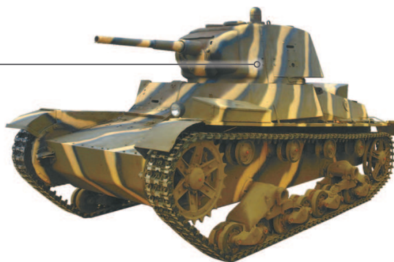
Однобашенный пушечный вариант танка Т-26 обр. 1938 г.
