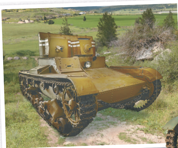
Двухбашенный вариант советского легкого танка Т-26, вооружение которого составляли один пулемет в одной башне и 37-мм противотанковая пушка в другой.
