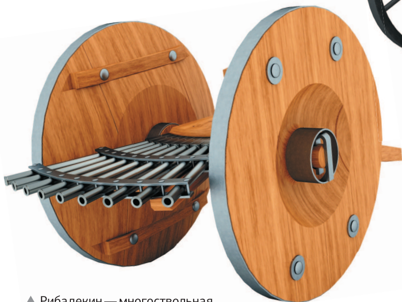
▲ Рибадекин — многоствольная стрелковая установка на колёсном шасси, заряжаемая с казённой части и стреляющая залпом. Применялась с середины XIV в.
