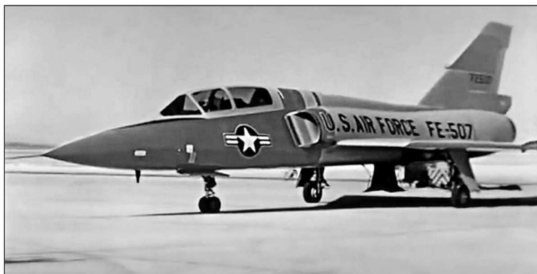
Один из прототипов спарки F-106B. Обратите внимание на конструкцию фонаря. Крылья имеют гребни. В серии их заменят «пропилами». Яркая окраска самолёта облегчает слежение за машиной во время испытаний
