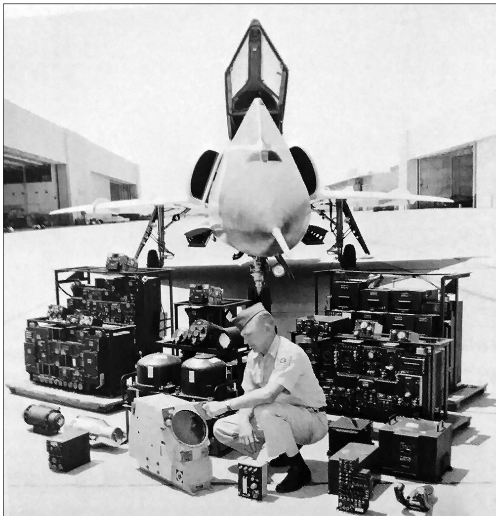
На фоне раннего варианта F-106 разложены блоки системы управления огнём Хьюз МА-1. Это была большая, громоздкая и тяжёлая система по сравнению с современными твёрдотельными элементами. Человек указывает на экран тактической обстановки
