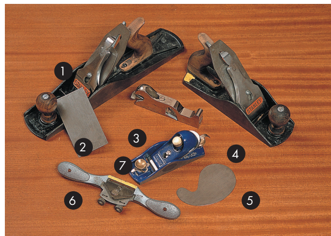
Рубанки и цикли: 1 — полуфуганок; 2 — базовая мебельная цикля; 3 — заплечиковый рубанок; 4 — шлифтик; 5 — S-образная мебельная цикля; 6 — струги; 7 — торцовый рубанок.
