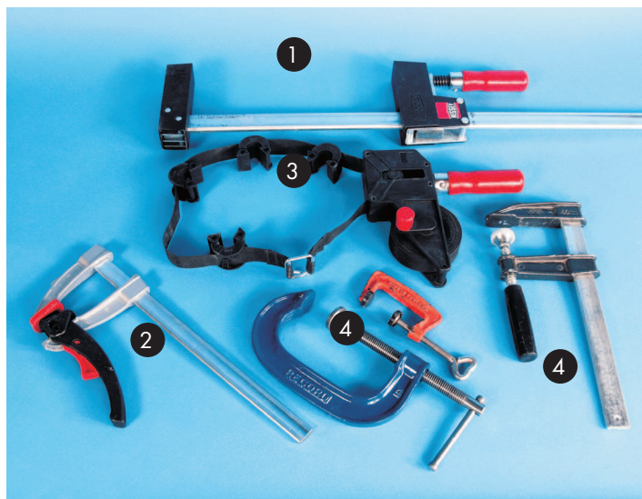
Струбцины: 1 — реечная струбцина; 2 — рычажная струбцина; 3 — ленточный зажим; 4 — струбцины с F-образным и G-образным зажимами.
