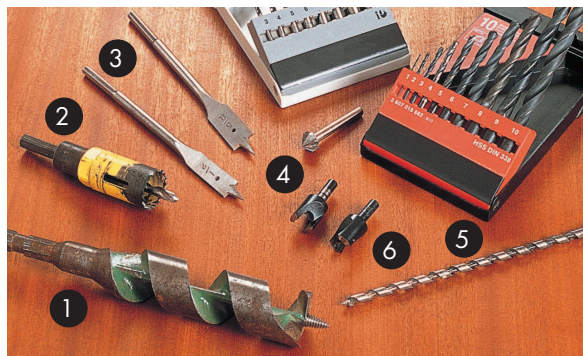
Сверла: в красном кейсе спиральные сверла из быстрорежущей стали, в сером кейсе центровые спиральные сверла со «шпорами». Оставшиеся сверла: 1 — винтовое сверло; 2 — коронка; 3 — плоское (перовое) сверло; 4 — зенковочное сверло; 5 — сверло по камню; 6 — пробочные сверла.
