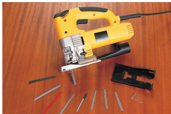
Мелкие зубья поворачивающейся пилки позволяют использовать лобзик для выпиливания сложных кривых. Эта модель оснащена патрубком для удаления пыли.
