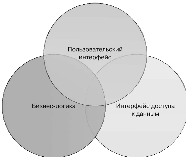
Рис. 1.3. Монолитное приложение представляет собой один большой компонент, содержащий все программное обеспечение
