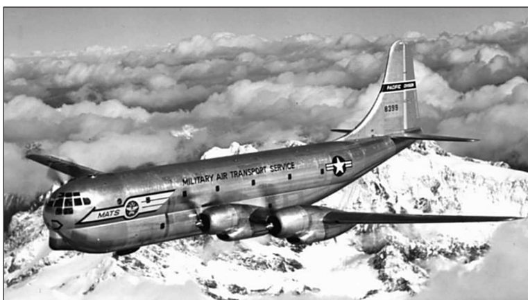
Транспортный самолёт Боинг С-97 Стратофритер. Обратите внимание на фюзеляж с сечением в виде восьмёрки и на отсутствие «ступеньки» в остеклении пилотской кабины
