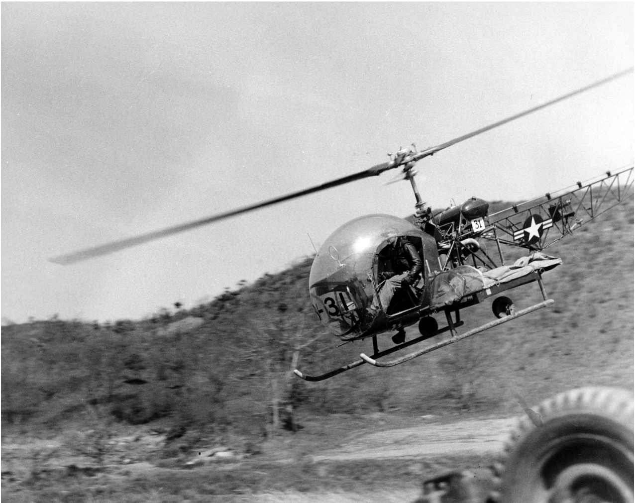
Вертолет ОН-13 в санитарном варианте с двумя носилками для перевозки раненых, Корея, 1952 г.
