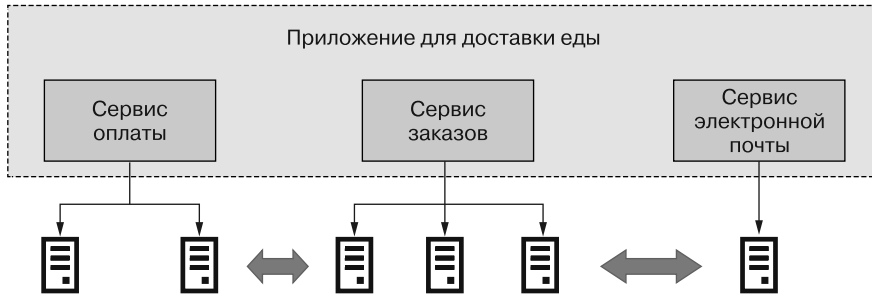
Рис. 1.1. В микросервисной архитектуре каждый сервис выполняет определенную бизнес-функцию и развертывается как независимый компонент, который выполняется в собственном процессе
