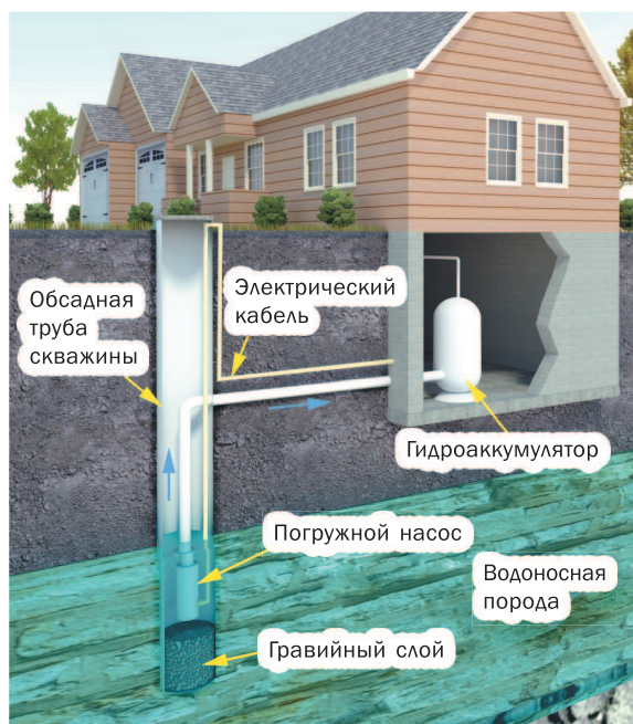
Водоснабжение от скважины
