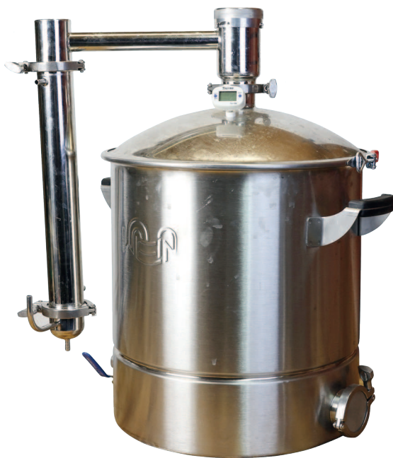
Самогонный аппарат прямоточного типа с кожухотрубным холодильником
