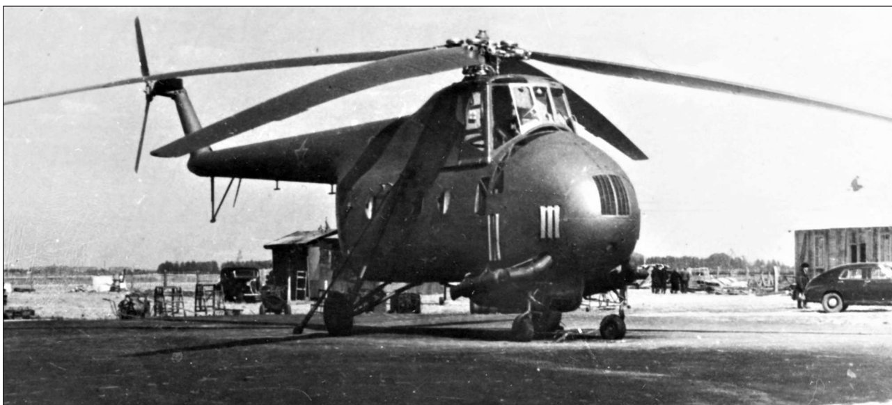
Второй прототип Ми-4 с шумопламяглушителями и антеннами радиовысотомера под хвостовой балкой на территории летно-испытательной и доводочной базы ОКБ-329 (оба снимка)
