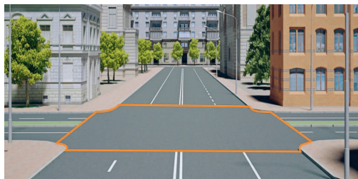
Границы перекрестка обозначены оранжевой линией и включают пересечение проезжих частей от начала их закруглений
