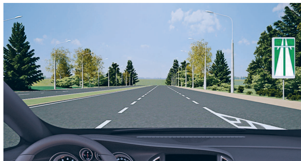
Автомагистраль – в данном случае дорога с тремя полосами движения в одном направлении и конструктивно выделенной разделительной полосой, обозначенная знаком 5.1. Справа видна разметка 1.16.3, обозначающая слияние проезжих частей
