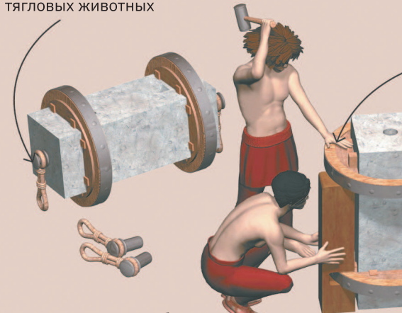
Конструкция и сборка строительной рамы-колеса Херсифрона.
