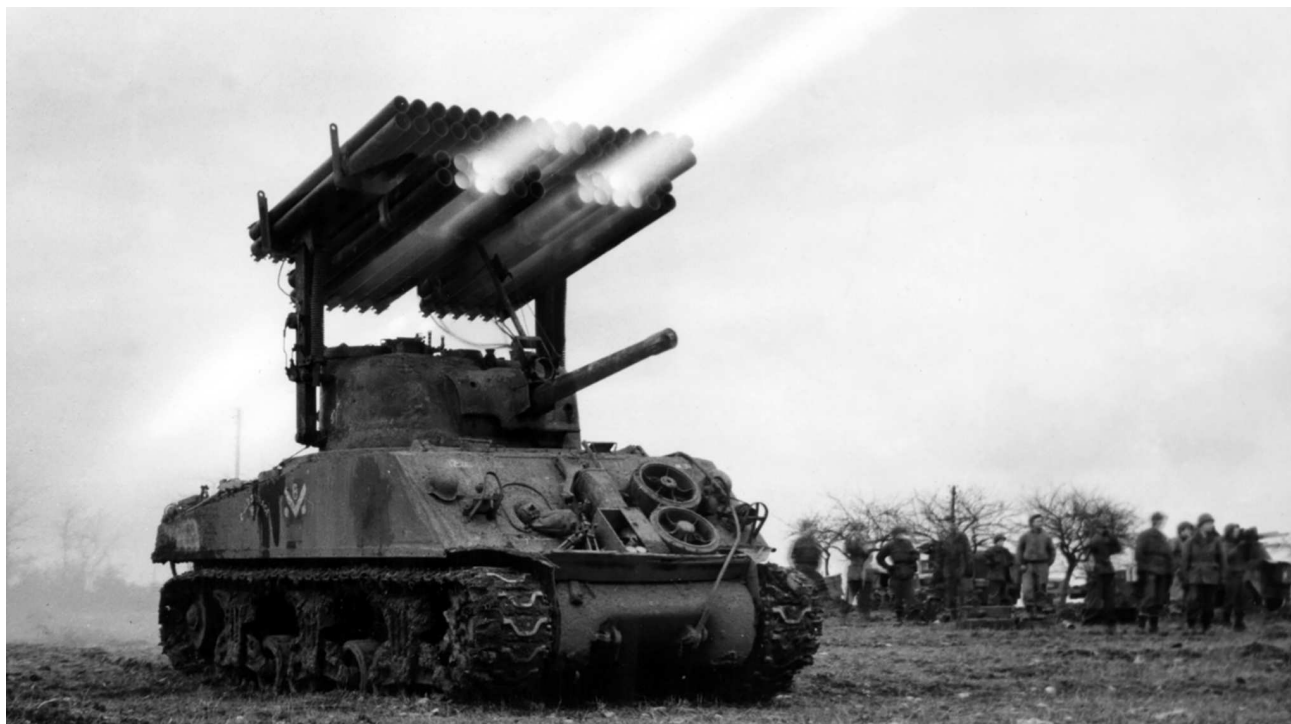
РСЗО типа Т34 «Каллиопа» ведет огонь 114-мм реактивными снарядами. 14-я бронетанковая дивизия СВ США, Франция (СВ США)
