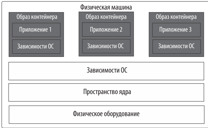
Рис. 1.5. Физическая машина, на которой работают три приложения в трех контейнерах
